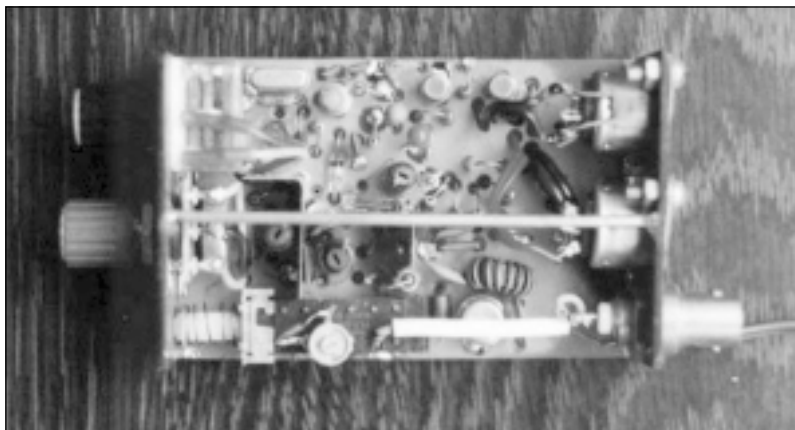
Obr. 4 – Pohľad na hotový mini QRP trans- ceiver na 3,5 MHz.
